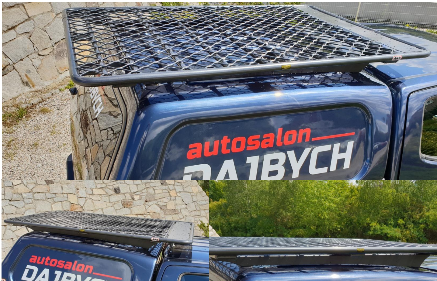
Na fotografiích je plochý hliníkový střešní nosič ARB 4913020M s rozměry 1790 x 1120 mm s mřížkovou pochozí podlahou.
