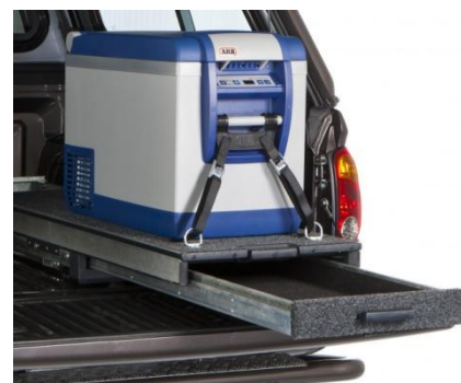
Nízká zásuvka s výsuvnou horní plochou Montáž vedle sebe nebo 2 kusy na sebe Vnější rozměry: 505 x 140 x 1355 mm obj. č. RF1355
