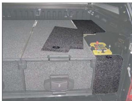
Boční krytí - sada (bez vyobrazené baterie) obj. č. MA12FK
